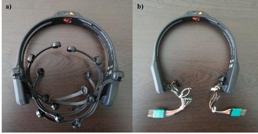
Şekil 4 a) Orijinal Epoc cihazı. (Original Epoc EEG device) b) Mikro kontrolcü için erkek soket kullanılarak uyarlanmış Epoc cihazı (Modified Epoc device with male sockets from microcontroller)
